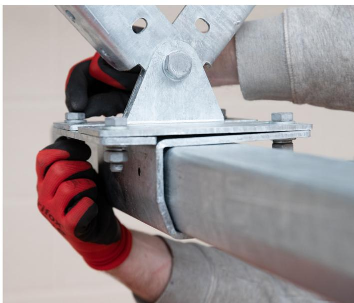
Des supports à double coque (brevet en instance) sont utilisés pour fixer le rail aux suspentes.
